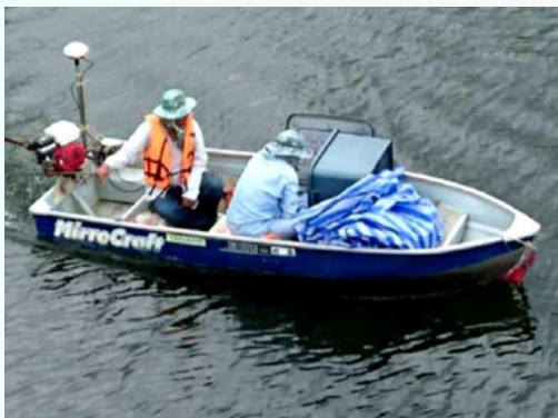
งานสำรวจความลึกพื้นท้องน้ำ บริเวณสถานีสูบน้ำดิบ หนองปลาไหล จังหวัดระยอง
